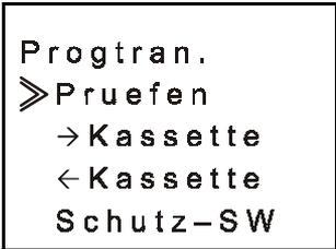
Die Option „<- Kassette“ dient dem Schreiben des Programms von der Speicherkassette in den internen Speicher der Alpha-Steuerung.
