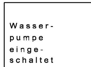
Die eingegebenen Zeichen werden nur angezeigt, wenn der Blockeingang des Anzeigeblocks eingeschaltet ist. Ist der Blockeingang ausgeschaltet, wird ein leerer Bildschirm angezeigt. Der Startbildschirm der Alpha-Steuerung wird bei der Verwendung des Anzeigeblocks nicht angezeigt.
